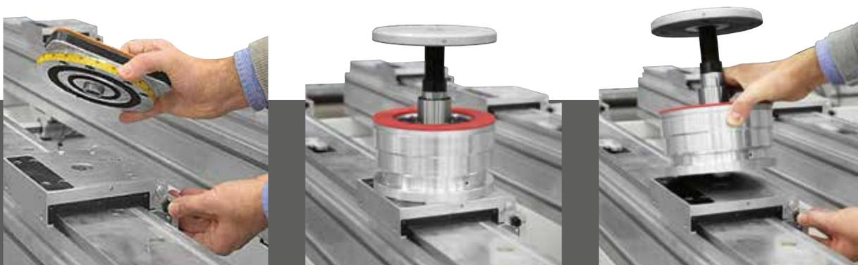
Da morsetti a ventose e viceversa in modo pratico e veloce. L'aggancio rapido messo a punto da SCM permette all'operatore la sostituzione dell'accessorio premendo semplicemente un pulsante.
