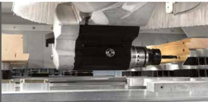
Zero manutenzione, massima flessibilità e ottima qualità di finitura con la tecnologia **BEL TECH (Belt Technology System)**, il sistema con rinvio a cinghia che annulla la trasmissione delle vibrazioni e del calore dall'utensile al motore. Questa particolare architettura consente lavorazioni ad asse orizzontale in spazi ridotti.
