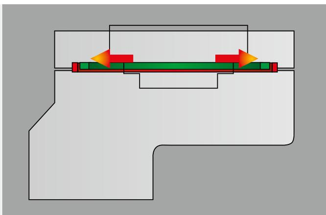
Tramite il sistema **TTS (Total Torque System)**, esclusivo SCM, l'asse rotante viene bloccato meccanicamente nelle lavorazioni ad utensile verticale, aumentando la rigidità del sistema.
