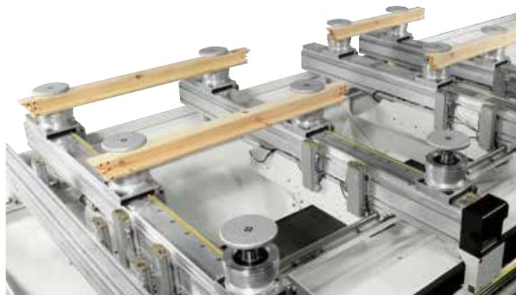
Caricare e scaricare i pezzi in modo agevole ed ergonomico, portarli in automatico in zona di lavoro ed evitare qualsiasi tipo di collisione è possibile grazie alla **totale gestione del piano di lavoro**. La pulizia avviene tramite sistemi di soffiaggio che rimuovono i trucioli sia dalla zona di scorrimento che dal piano di appoggio pezzo; questa funzione rende il piano MATIC ideale per la lavorazione di elementi in prefinito, che prevedono riposizionamenti del pezzo all'interno del programma.
